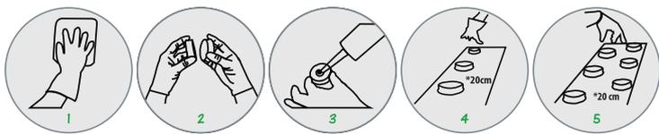
1. La surface doit être nettoyée et séchée avant application. Ne pas appliquer le produit lors de jours de pluie afin d'éviter tout problème d'adhérence du silicone.
